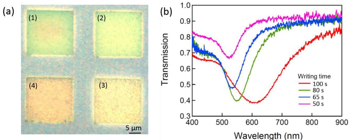
**Figure 7.** Images microscopiques (a) et spectres de transmissions (b) des nanoparticules d'or fabriquées par la méthode d'écriture directe par laser, par une puissance de 40 mW et avec les temps d'exposition différents: (1) 100 s, (2) 80 s, (3) 65 s, (4) 50 s.
