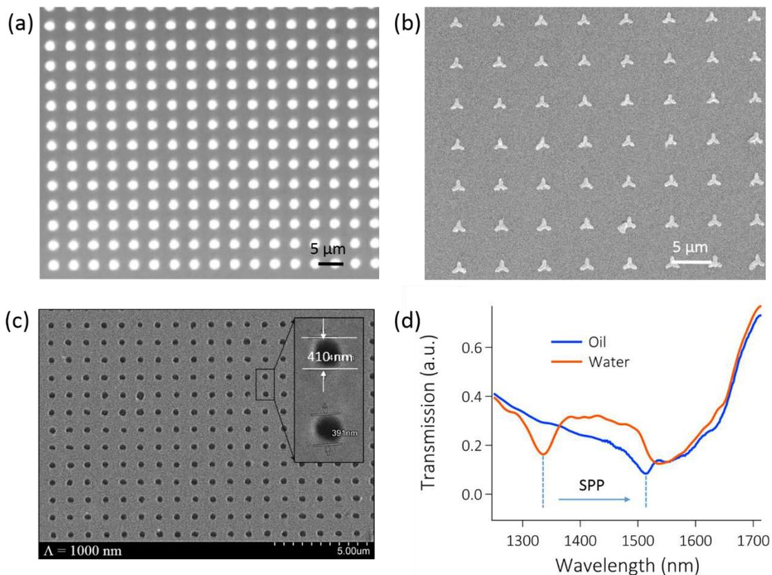
**Figure 4.** (a) Image au MEB d'un réseau de disques en or. (b) Image au MEB d'un réseau d'étoiles en or. (c) Image au MEB d'un réseau de nano-trous en or. (d) Spectres de transmission d'une structure GNHA en différents milieux.
