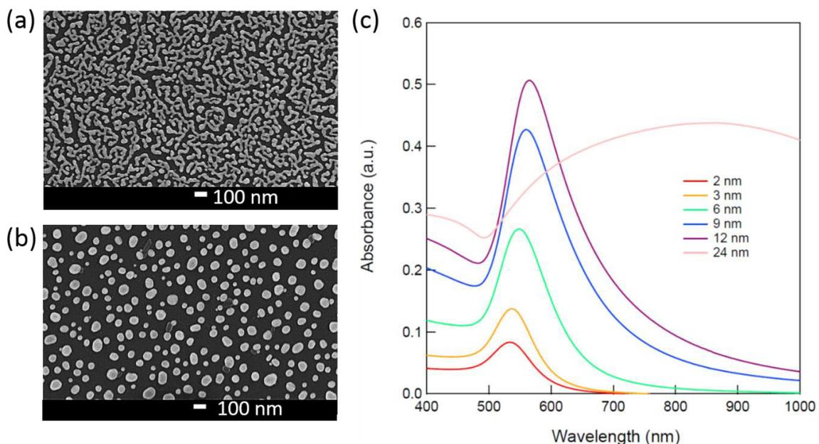
**Figure 5.** (a) Images au MEB d'un film d'or de  $10\ \text{nm}$  obtenu par pulvérisation sur substrat de verre. (b) Le film correspondant après réticulation de 30 minutes à  $500^\circ\text{C}$ . (c) Spectres UV-VIS de films d'or de différentes épaisseurs, après pulvérisation sur substrat de verre et réticulation à  $500^\circ\text{C}$ .
