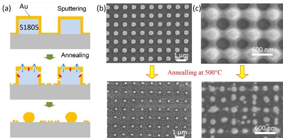
**Figure 6.** (a) Schéma du mécanisme expliquant la formation de réseaux en or. (b), (c) Images au MEB de matrices photo-résine recouvertes de couches d'or pulvérisé (épaisseur = 10 nm) et la structure en or correspondante obtenue après réticulation à 500°C pendant 30 minutes.
