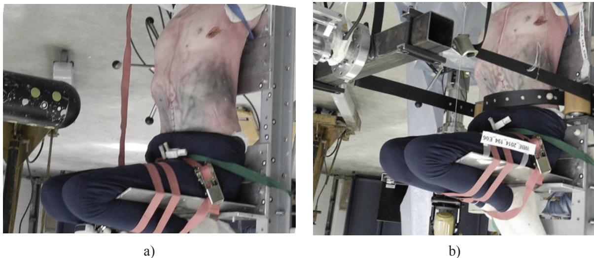
Figure 26 : Sujet mis en position avec l'impacteur rigide (a) et montage utilisé pour le chargement ceinture (b)
