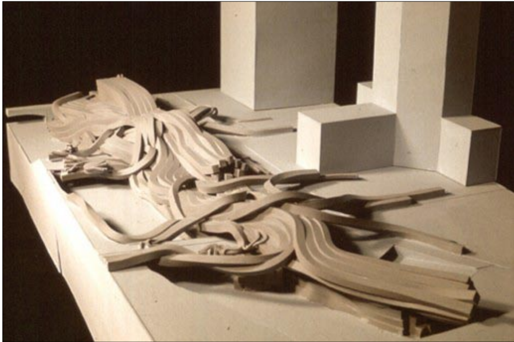
fig. 3: Greg Lynn, maquette pour la Stranded Sears Tower , Chicago, 1992 (non réalisée). Premier projet théorique de Greg Lynn. La tour initiale est réinterprétée comme une typologie horizontale d'édifice. Des structures tubulaires à sections carrées de 7,6m de haut ménagent des cheminements pour les voitures, piétons et autres flux pour connecter le bâtiment à la rivière. © Greg Lynn FORM (online)
