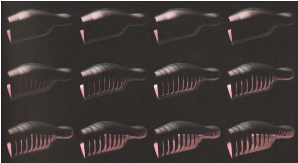
fig. 41: Greg Lynn, Korean Presbyterian Church , (1995-1999). Variation du blob structurant l'intérieur du sanctuaire. Les courbes sont orientées parallèlement à la structure existante. Cette séquence a permis ensuite de « lacérer » le volume pour y faire entrer de la lumière naturelle ou artificielle. Source : M. Rappolt, Greg Lynn FORM , 2008, p.88. © Greg Lynn FORM.
