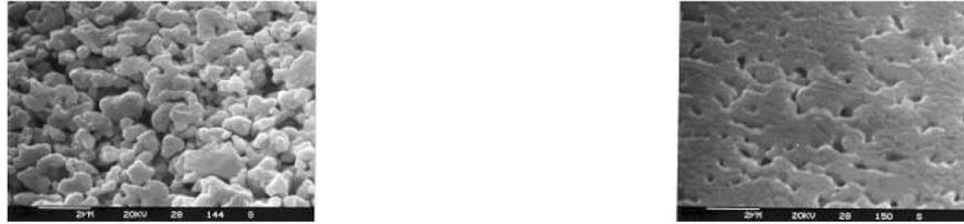
(a) : Porosité du frittage de microparticules d'argent (b) : Porosité du frittage de nanoparticules d'argent
