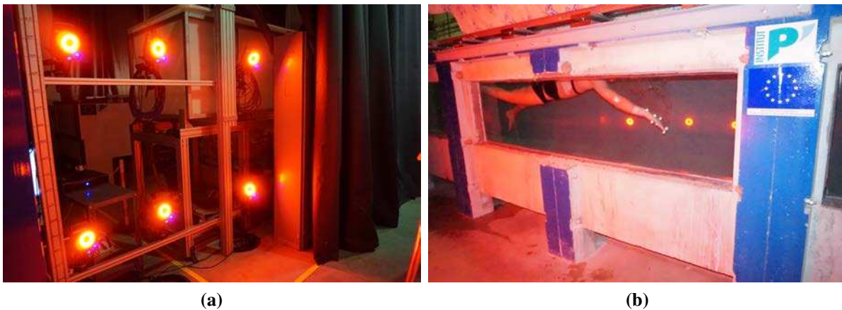
FIGURE 6.2 – (a) Disposition des 6 caméras latérales autour du bassin ; (b) vue à travers le hublot latéral, d'un nageur attaché.
