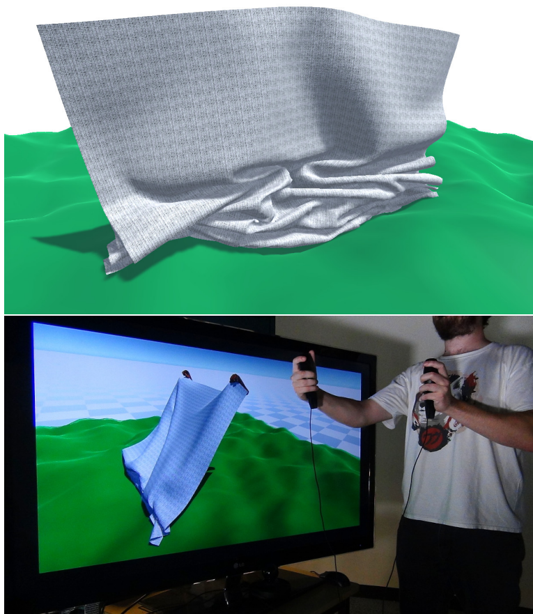
Figure 3.31 – Test de stress, un drap tombe sur sa tranche sur un sol irrégulier (haut). Dans ce scénario, des auto-collisions complexes ont lieu et notre méthode les détecte correctement. Cette scène peut être manipulée par un utilisateur (bas). Notre méthode tourne en temps-réel et permet donc l’interaction directe avec un utilisateur.
