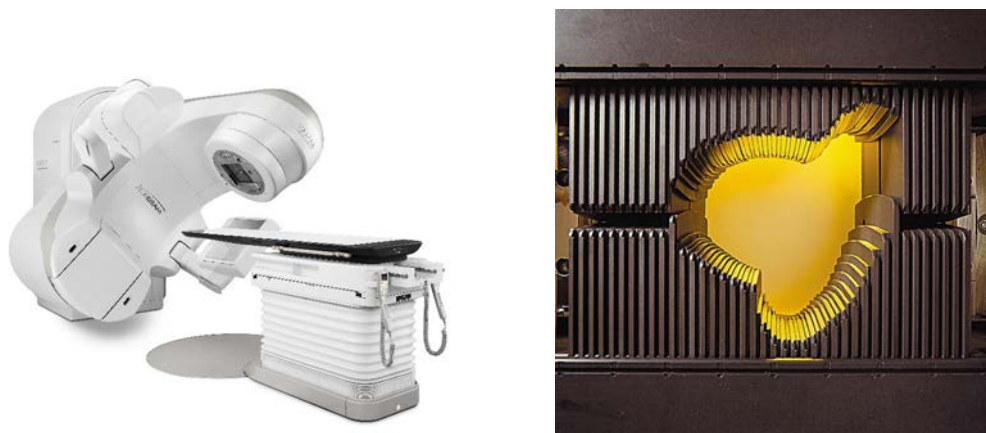
FIGURE 1.5 – Accélérateur linéaire et MLC utilisés en radiothérapie externe actuelle. Source : 1.5(a) ehealthconnection , 1.5(b) Varian .
