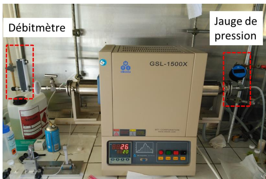
Figure II-7 : Photographie du four utilisé pour la synthèse du MoS 2 par CVD.
