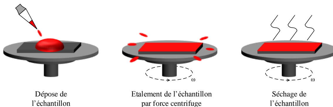
Figure I-12 : Procédé de dépôt par spin-coating [107].
