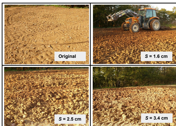
FIGURE 7.8 Zone d'expérimentation pour différentes valeurs de rugosité de surface s
