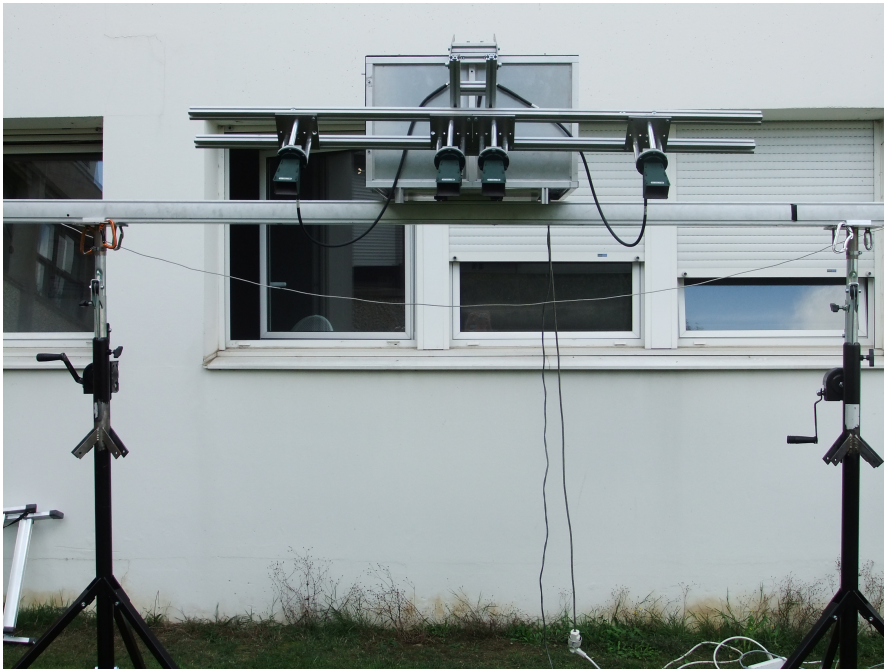
FIGURE 6.17 Système expérimental d'imagerie MIMO SAR
