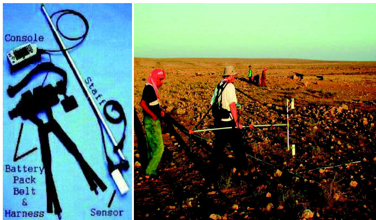
Figure 3.1 : A gauche le magnétomètre Geometrics G-858 et à droite un profil magnétique en cours d'acquisition (S. Gondet. © Mission archéologique d'Al-Rawda).
