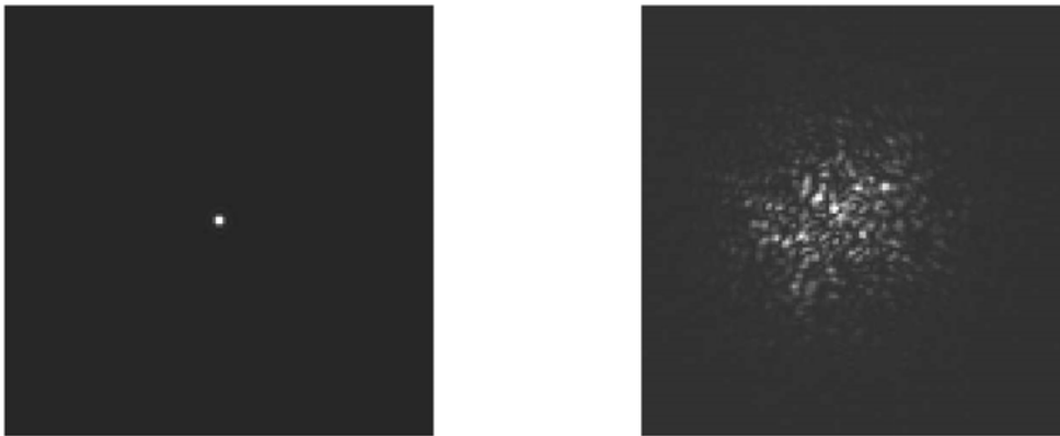
Figure 1.7 : Différence entre une FEP sans turbulence atmosphérique et avec turbulence. D / r_0 est égal à 20. Source : [Thomas2006].
