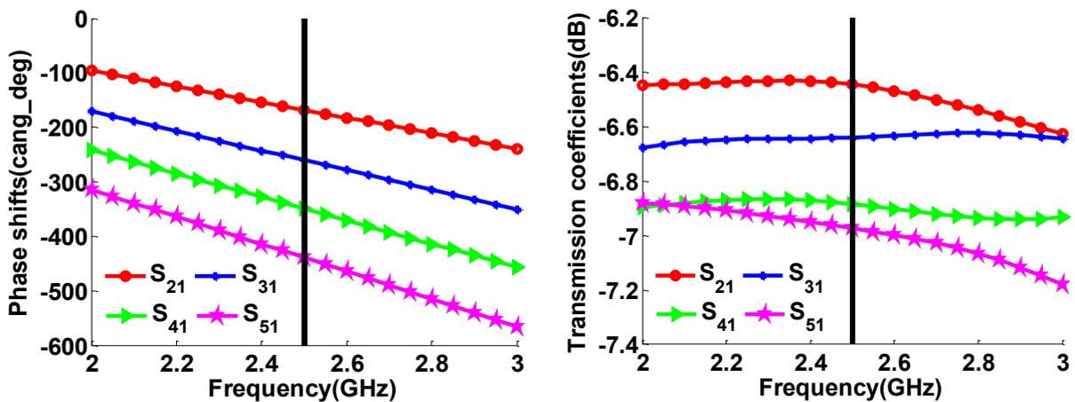
Fig. 3: Caractéristiques simulées du déphaseur: les déphasages (à gauche) et les coefficients de transmission (à droite) à 2.5 GHz. Le déphasage des  $S_{21}$ ,  $S_{31}$ ,  $S_{41}$ ,  $S_{51}$  est de  $-168^\circ$   $-261^\circ$   $-350^\circ$   $-439^\circ$ , respectivement; et leur amplitude, de  $-6.4$  dB,  $-6,6$  dB,  $-6,9$  dB,  $-7$  dB.
