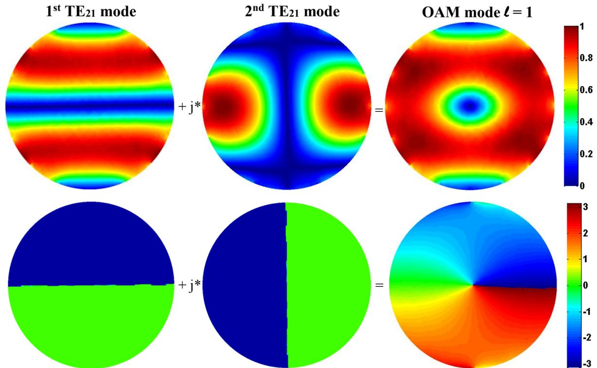
Fig. 25: Evolutions des diagrammes en amplitude (en haut) et en phase (en bas) de la composante  $E_y$  pour la génération d'une onde OAM, en combinant deux types de mode de  $TE_{21}$  avec une différence de phase de  $\pi/2$  entre les deux
