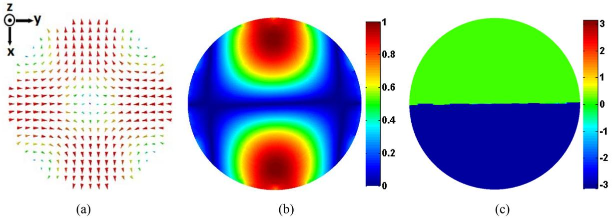
Fig. 23: Mode guidé classique  $TE_{21}$  (deuxième type) le guide d'onde circulaire : (a) Distribution de champ électrique; (b) Amplitude normalisée de la composante  $E_x$ ; (c) Phase de la composante  $E_x$
