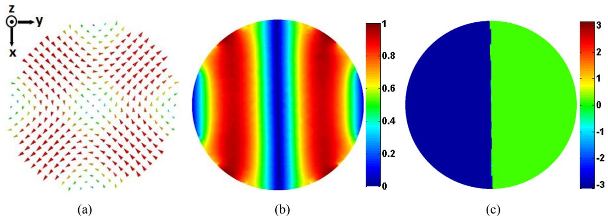
Fig. 22: Mode guidé classique  $TE_{21}$  (premier type) le guide d'onde circulaire : (a) Distribution de champ électrique; (b) Amplitude normalisée de la composante  $E_x$ ; (c) Phase de la composante  $E_x$
