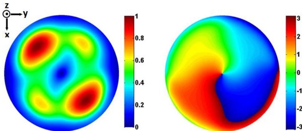
Fig. 21: Cartographie en amplitude normalisée (à gauche) et en phase (à droite) de la composante  $E_x$  du champ électrique à la fréquence de 7.4 GHz et à 1cm de l'ouverture du cornet excitée par deux demi-SPPs
