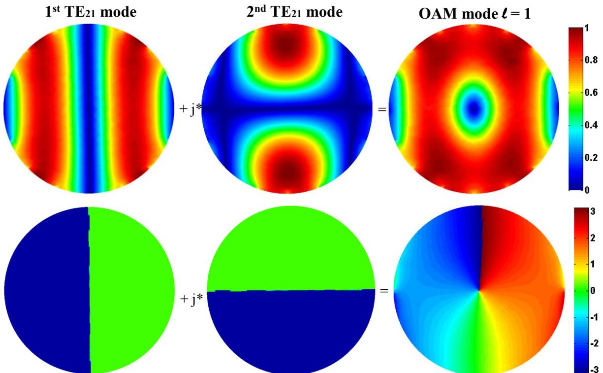
Fig. 24: Evolutions des diagrammes en amplitude (en haut) et en phase (en bas) de la composante  $E_x$  pour la génération d'une onde OAM, en combinant deux types de mode de  $TE_{21}$  avec une différence de phase de  $\pi/2$  entre les deux
