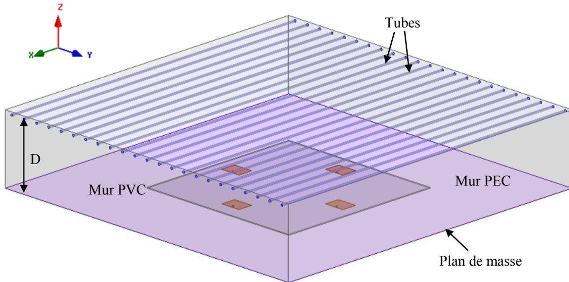
Fig. 9: Géométrie de l'antenne à cavité FP
