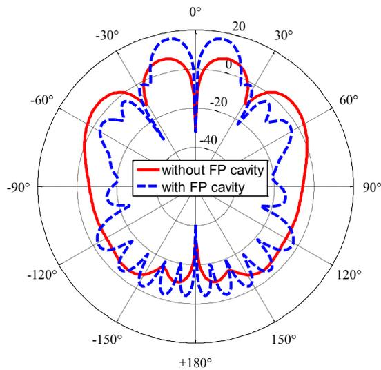
Fig. 11: Comparaison des diagrammes de rayonnement dans le plan E de l'antenne OAM avec et sans cavité FP (rayon de réseau égal à 110mm)
