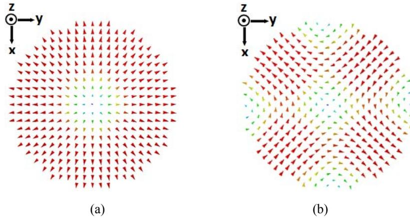
Fig. 26 : Distributions du champ électrique pour les modes  $TM_{01}$  et  $TE_{21}$  : (a)  $TM_{01}$  (b)  $TE_{21}$  de type 1
