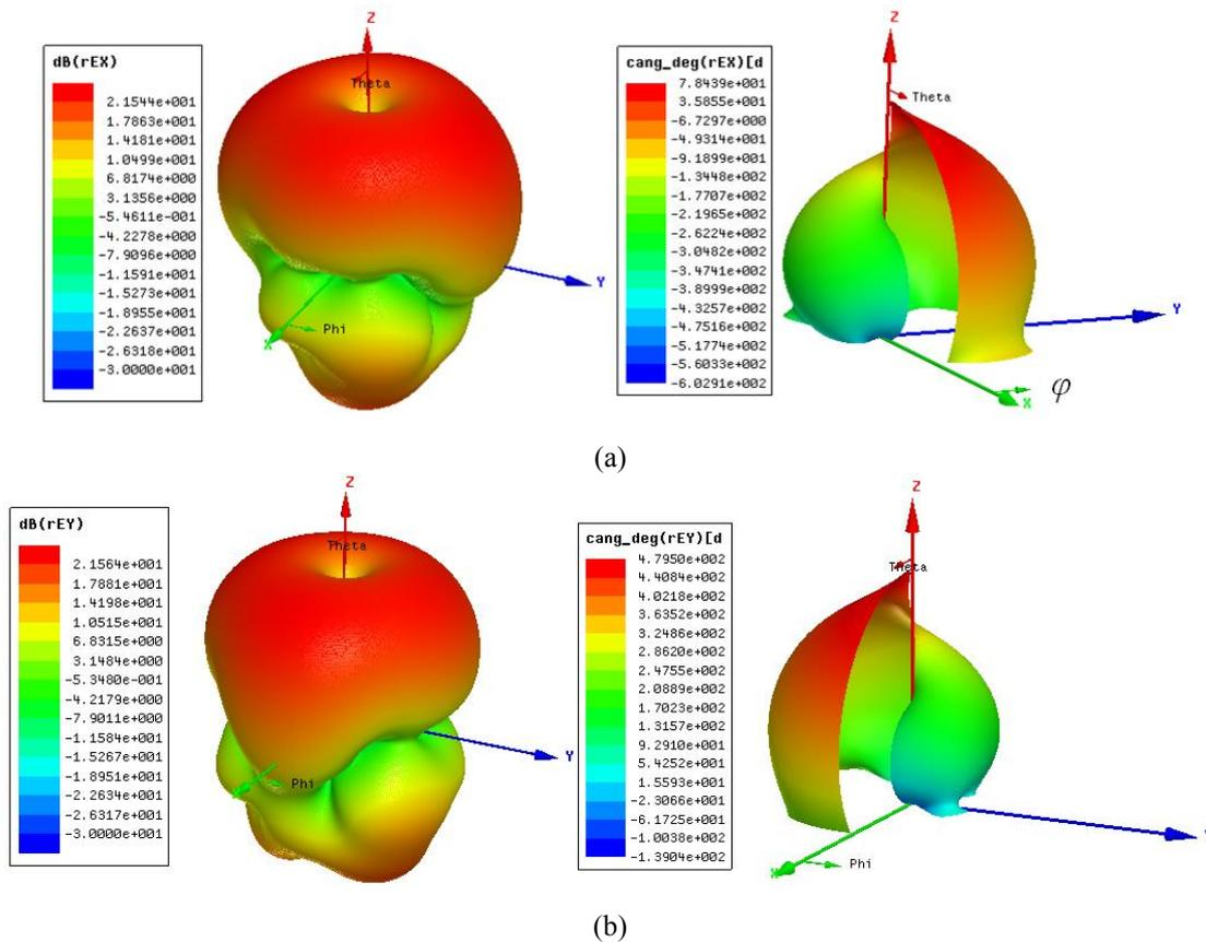
Fig. 29 : Diagrammes de rayonnement (à gauche) et de phase (à droite) 3D de l'antenne OAM à 8.3 GHz : (a) Composante  $E_x$ ; (b) Composante  $E_y$
