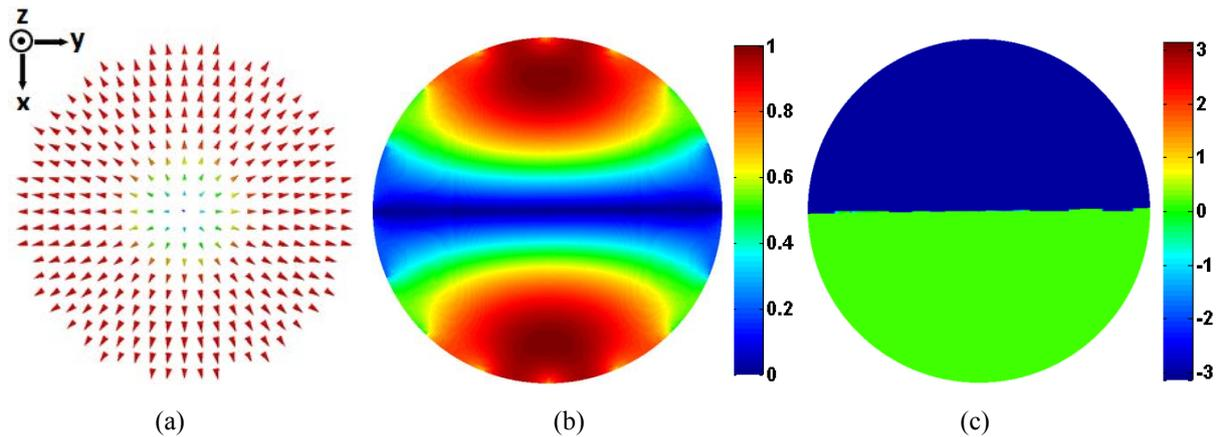
Fig. 18: Mode guidé classique  $TM_{01}$  dans un guide d'onde circulaire : (a) Distribution de champ électrique; (b) Amplitude normalisée de la composante  $E_x$ ; (c) Phase de la composante  $E_x$ .
