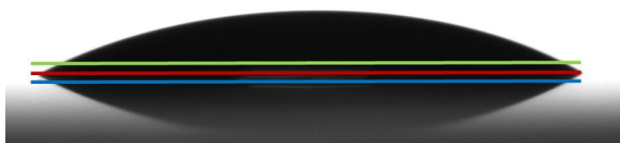
Figure 3 : Trois lignes de contact différentes pour le calcul de l'angle d'un profil de goutte capturé avec la caméra du DSA100
