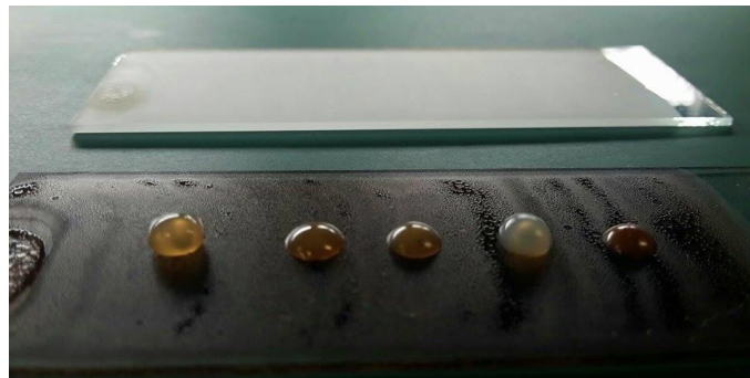
Figure IV-9 : Illustration de deux lames de verre ensimées dont l'une a été portée à 25°C (celle du haut) et l'autre à 240°C (celle du bas)
