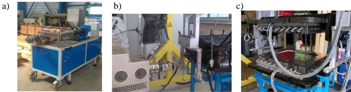
Figure VI-1 : Photographies de l'extrudeuse, du pot de transfert (a), de l'unité d'injection (b) et du moule (c)
