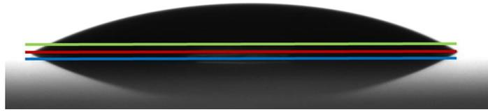
Figure 3 : Trois lignes de contact différentes pour le calcul de l'angle d'un profil de goutte capturé avec la caméra du DSA100
