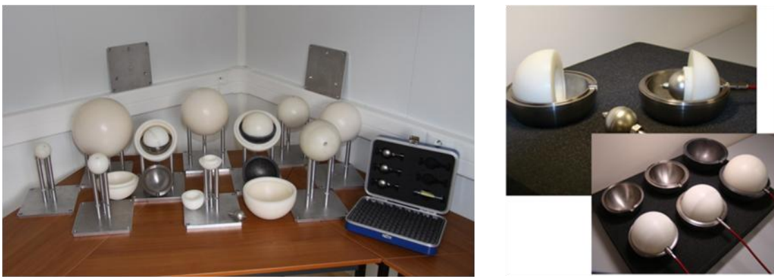
Figure A.1 Ensemble des sphères de Bonner qui composent le système HERMEIS (gauche) et les trois sphères entourées des coques en matériau lourd dédiées à la détection des neutrons de haute énergie ( E > \sim 20 MeV) (droite).
