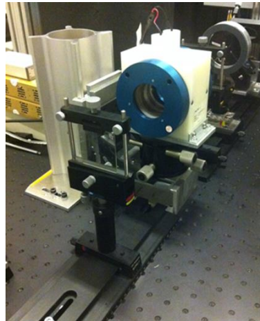
Figure 2-41 : Photographie de la cellule de Pockels placée entre deux polariseurs croisés.
