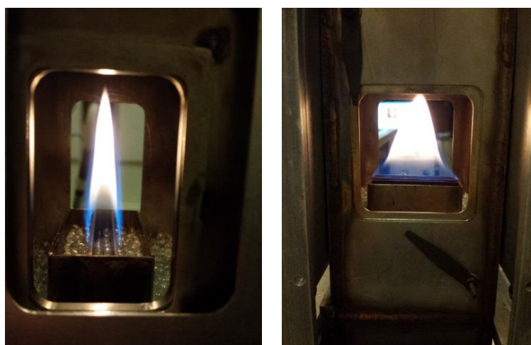
Figure 2-5 : Photographie de flamme de diffusion laminaire de méthane air stabilisée sur un brûleur de référence de type Wolfhard-Parker.
