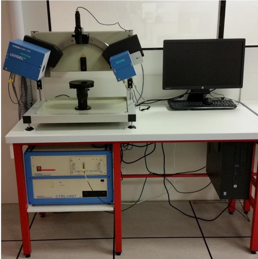
Figure A.4 : Photographie de l'ellipsomètre Uvisel Horiba.
