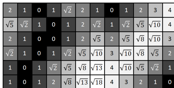
Figure 27 : Carte de distance L^2 pour l'image utilisée sur la Figure 26. Elle n'est pas déterminable par simple propagation.
