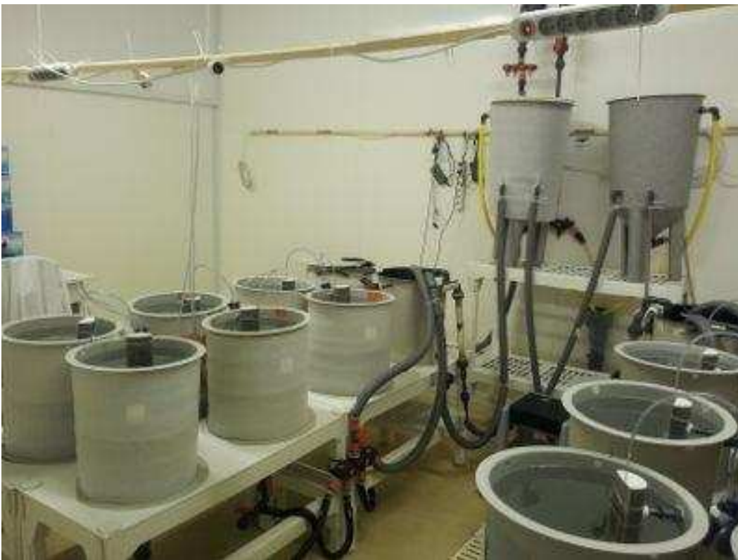
Figure 15: Disposition expérimental du common garden embryo-larvaire, avec dans le fond les châteaux d'eau permettant une distribution constante de l'eau de mer aux incubateurs, localisés au premier plan. (Photo : Nicolas Pedron)
