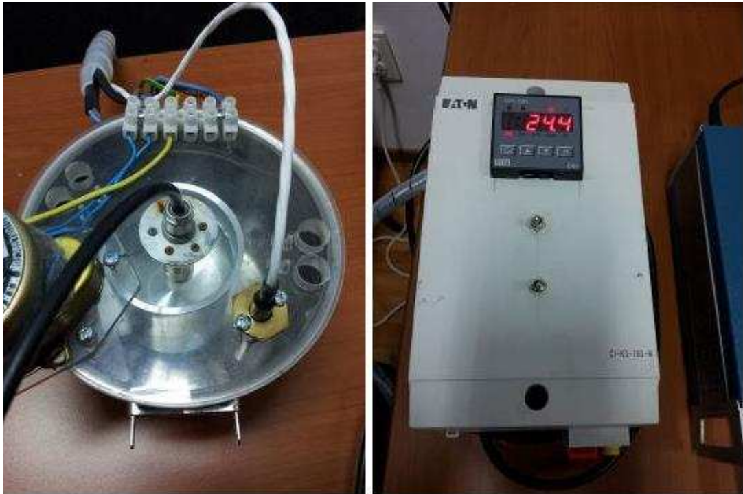
Figure 5.4: Récipient thermo-contrôlé (gauche) et bloc électronique de contrôle (droit)
