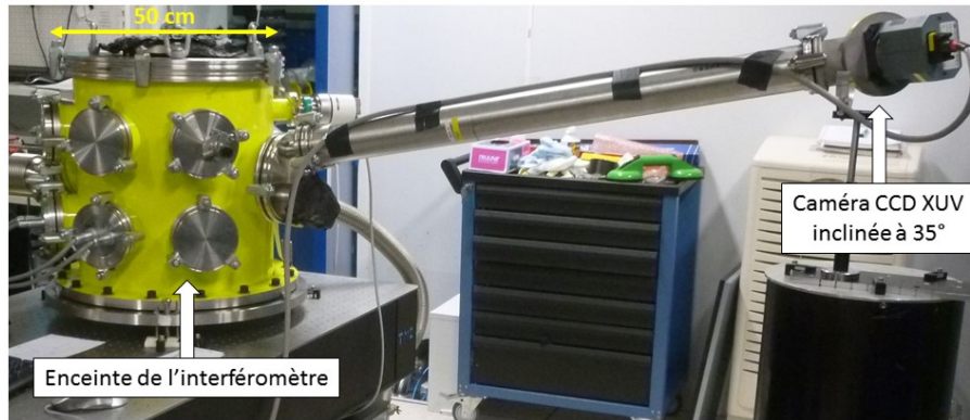
FIGURE 2.3 – Photo de l'enceinte de l'interféromètre et du tube menant à la caméra CCD XUV inclinée à 35°.
