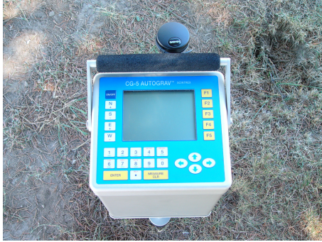
FIGURE 1.13 – Gravimètre relatif - Scintrex CG5, (©Scintrex).
