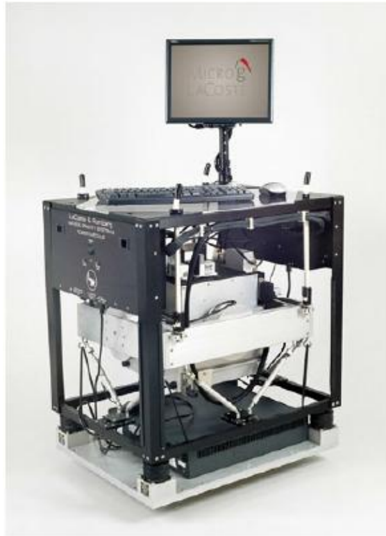
FIGURE 1.16 – Gravimètre aérien/marin LaCoste & Romberg montée sur sa plate-forme stabilisée ©Micro-g Lacoste Inc.
