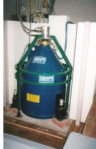
FIGURE 1.14 – Gravimètre supraconducteur GWR C026 à l'EOST Strasbourg, (©EOST).
