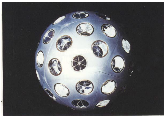
FIGURE 1.18 – Le satellite STARLETTE lancé par le CNES en 1975. Une sphère de 250 mm de diamètre, couverte de 60 réflecteurs.
