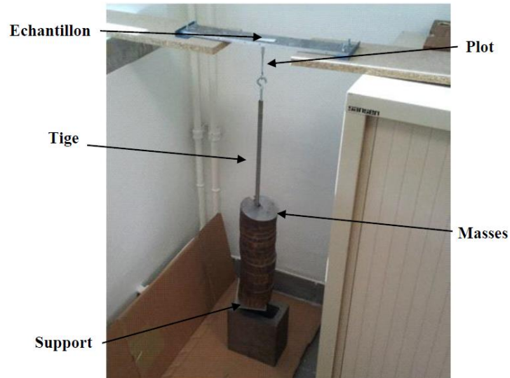
Figure 7 : Test de traction mis en place au sein du laboratoire LT2C
