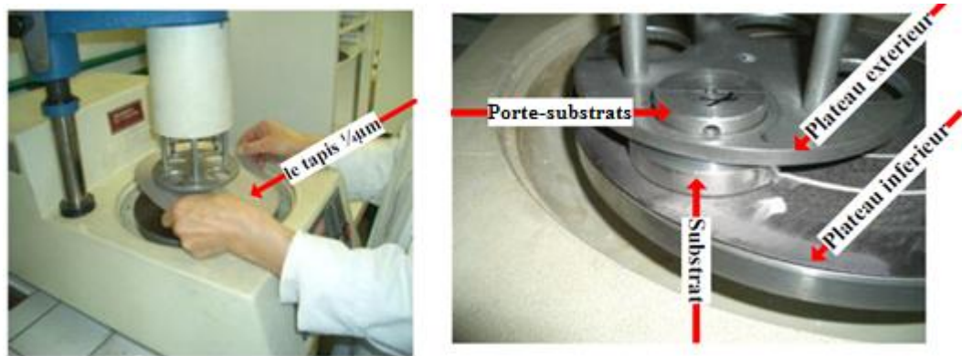
Figure 10 : Procédé du polissage
