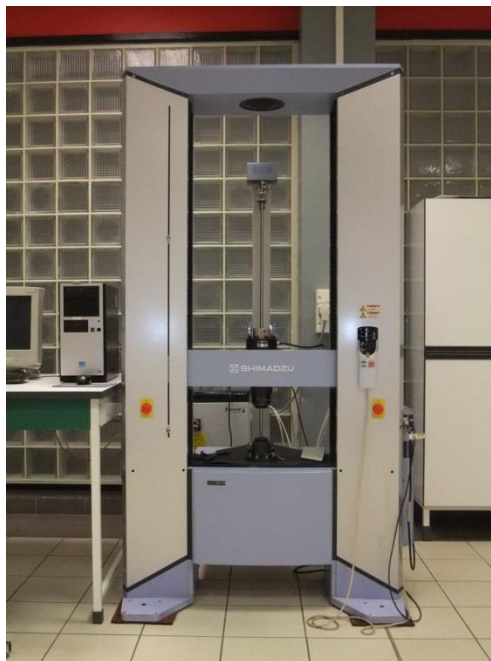
Figure 3 : Essai de traction pour des matériaux massifs
