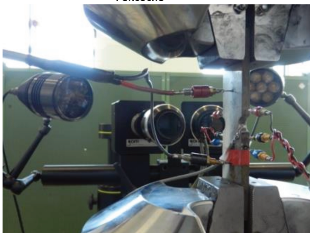
Figure 91 : Epreuve instrumentée entre les mors : jauge de déformation, stéréo-corrélation et mesure ACPD
