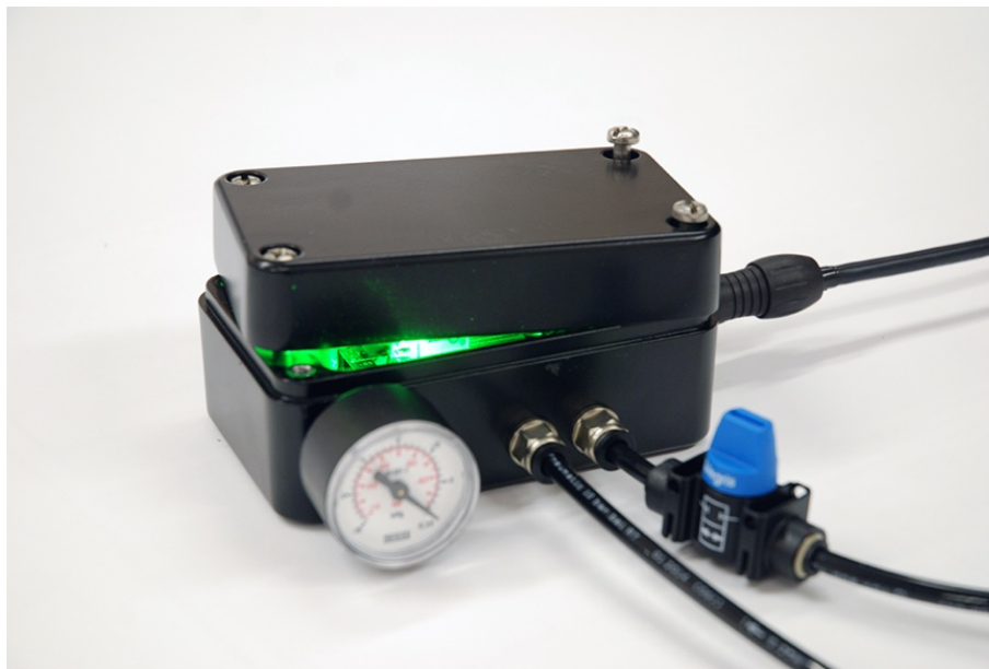
Figure II-26. BlackBox v.4 en aluminium avec un joint d'étanchéité (non visible) pour éviter toute sorte de pollution électromagnétique venant de l'extérieur. La seule source lumineuse est la LED verte.
