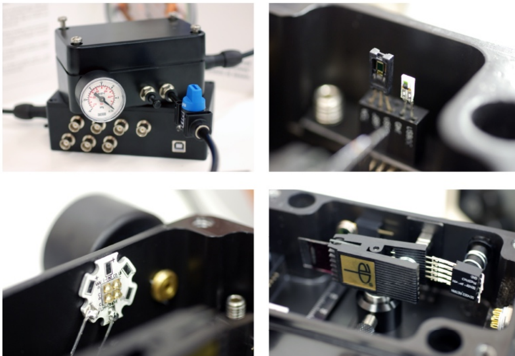
Figure II-17. La version finale et la plus avancée de la BlackBox (v. 4). Sur les photos sont visibles le manomètre, les capteurs d'humidité, de température, la LED, la pince avec le photodétecteur organique et la photodiode inorganique Si (située derrière la pince).
