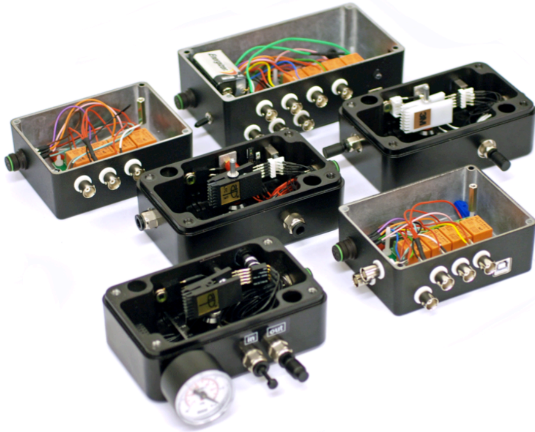
Figure II-18. Les trois BlackBox (v.4) avec leurs boîtiers électroniques respectifs.
