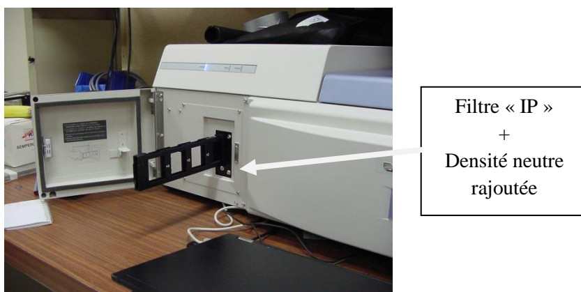
Figure 193 : Mise en place d'une densité calibrée (facteur 430) devant le filtre « IP » du FLA7000
