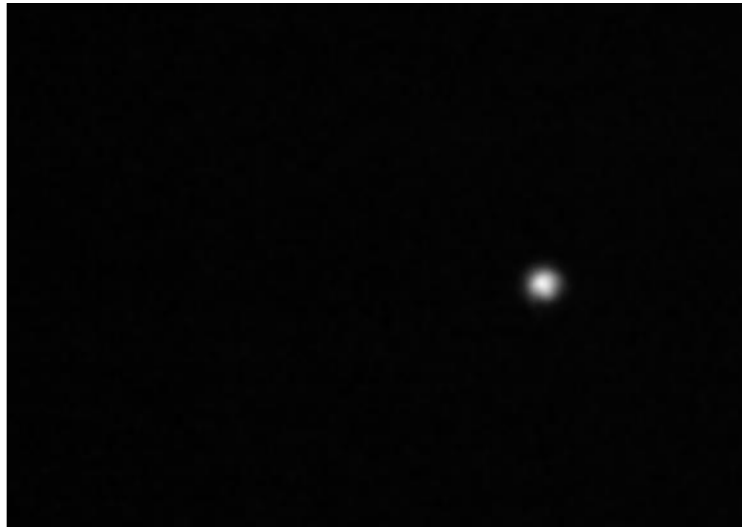
Figure 59 : Vue agrandie de la forme du faisceau au centre de la maquette au premier passage.
