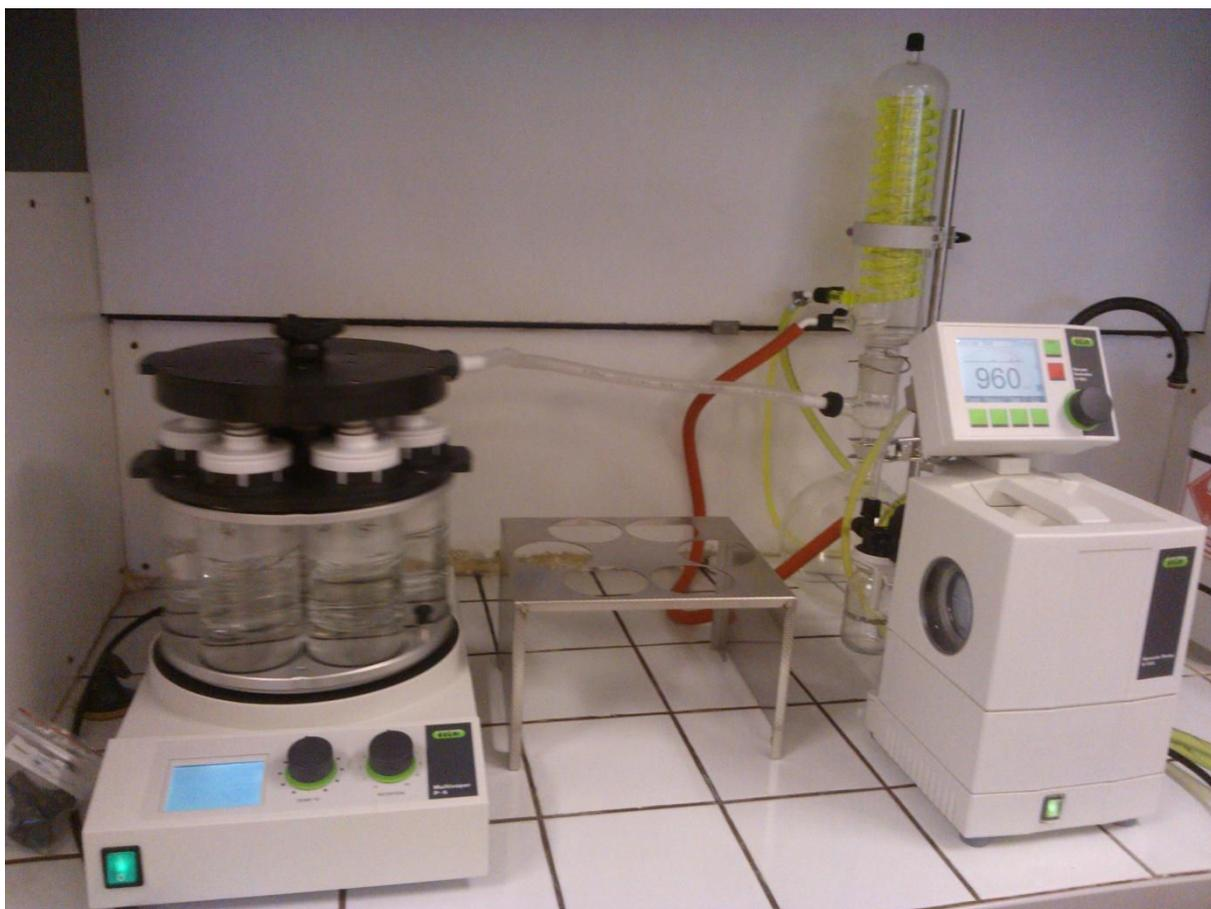
Figure 2 : multi-évaporateur rotatif
