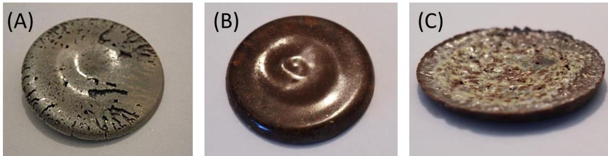
**Figure 22** : Aspect de surface de la cible obtenue sans agitation à haute température vue de dessous (**A**) et avec agitation à haute température, vue de dessous (**B**) et de dessus (**C**).
