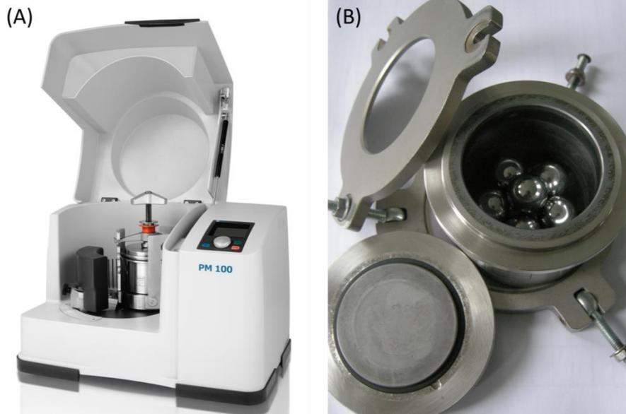
Figure 7 : Appareil de broyage PM100 (A) et bol et billes de broyage en carbure de tungstène (B) utilisés pour la préparation des poudres amorphes.
