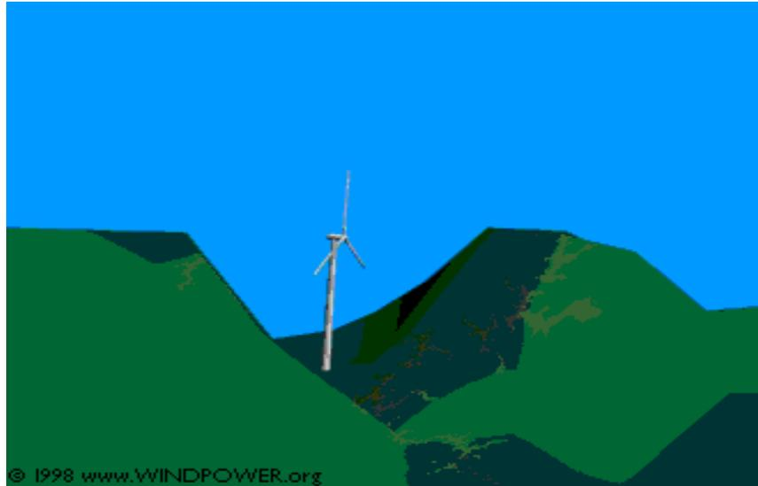
Figure II-7 : Effet d'accélération de la vitesse de vent par effet tunnel
