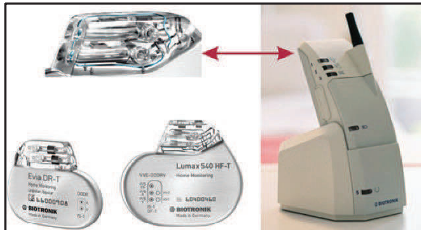
Figure 1 – Dispositifs (en bas à gauche), Antenne (en haut à gauche) et transmetteur mobile (à droite) - Système Biotronik Home Monitor Cardiomessenger
