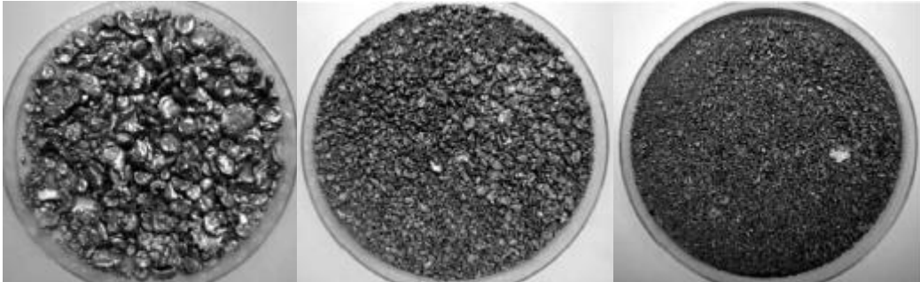
Figure 8-7 : Images de fragments solidifiés pour différentes vitesses d'injection. gauche) 2,10 m/s, centre) 3,92 m/s et droite) 5,0 m/s (Abe et al., 2006)
