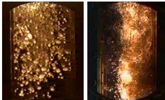
Figure 1-3 : Visualisation de prémélange avec de l'alumine (à gauche, expérience KROTOS-57) et du corium (à droite, expérience KROTOS-58). La fenêtre de visualisation est de 10 x 20 cm.
