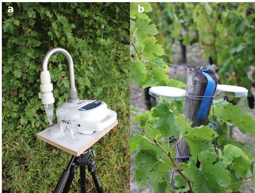
Figure 2.5 – Pièges utilisés afin de capturer les bioaérosols. (a) Capteur Coriolis, piégeant activement les bioaérosols dans un liquide à l'aide d'un flux d'air. (b) Paire de pièges passifs, composés d'un papier filtre scotché au dos d'une boîte de Pétri accrochée à un piquet de vigne.
