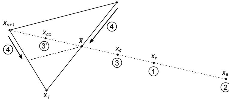
**Figure 9.2** – Illustration des opérations possibles sur un simplexe dans un espace à deux dimensions. Le triangle continu représente le simplexe de base, les différents points sont les déplacements possibles du plus mauvais point, et la ligne discontinue illustre la réduction du simplexe. Adapté de Lagarias et al. (1998).
