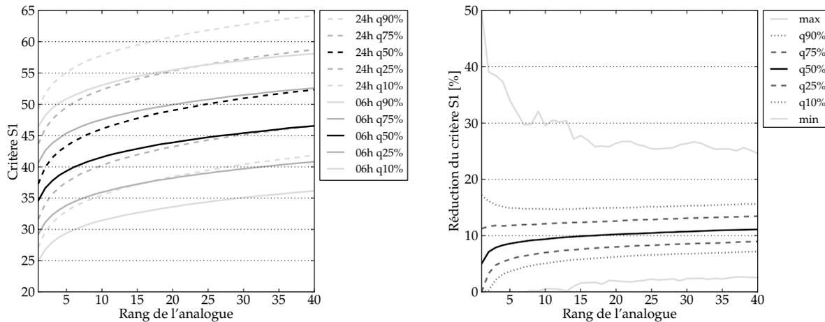
**Figure 8.3** – Synthèse du gain sur le critère S1 à la station d'Ulrichen, pour les différentes analogues, dû à la fenêtre temporelle glissante. (gauche) Quantiles de la distribution des valeurs de S1 avec (06h) et sans (24h) la fenêtre glissante. (droite) Quantiles des gains sur le critère S1 par l'utilisation de la fenêtre glissante.
