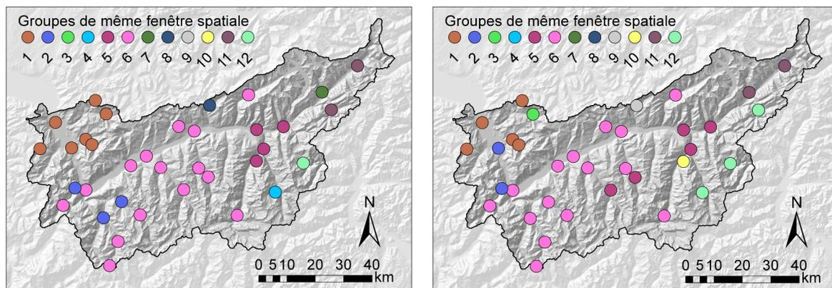
**Figure 5.2** – Cartes des stations partageant la même fenêtre spatiale pour la méthode R1 (géopotential à 500 hPa et 1000 hPa). Les paramètres sont optimisés pour la série de précipitations (gauche) avec traitement par la racine carrée et (droite) sans ce traitement. (Géodonnées © swiss-topo – DV084371)
