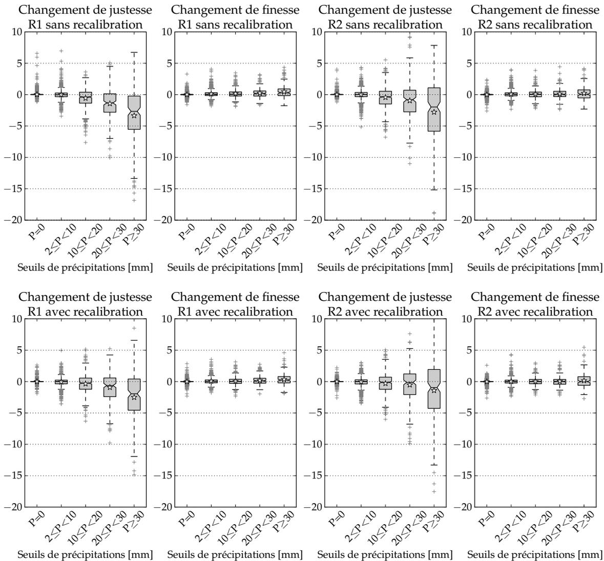
**Figure 8.9** – Influence de la fenêtre temporelle glissante sur les composantes du CRPS (justesse et finesse), pour les méthodes R1 et R2. Les résultats sont présentés pour (haut) les paramètres originaux et (bas) recalibrés. Une amélioration de la prévision se traduit par une baisse du score.
