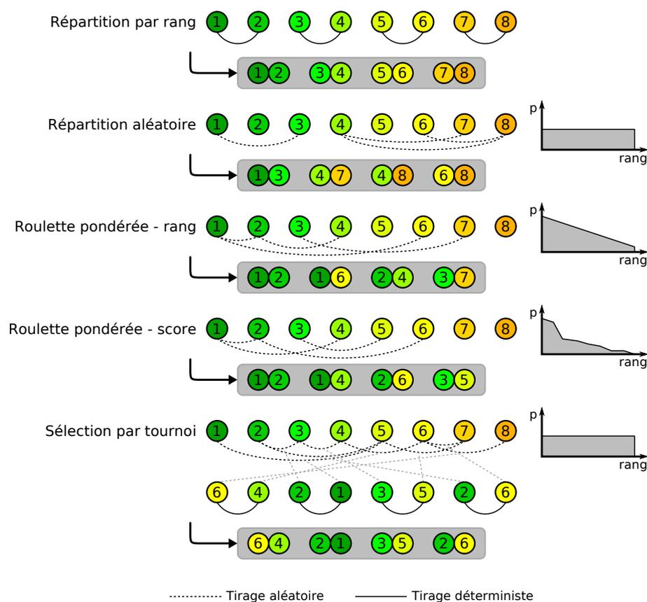
**Figure 9.9** – Illustration des différents opérateurs de sélection des couples implémentés dans les AGs. Les distributions à droite illustrent la probabilité de sélection en fonction du rang de l'individu.
