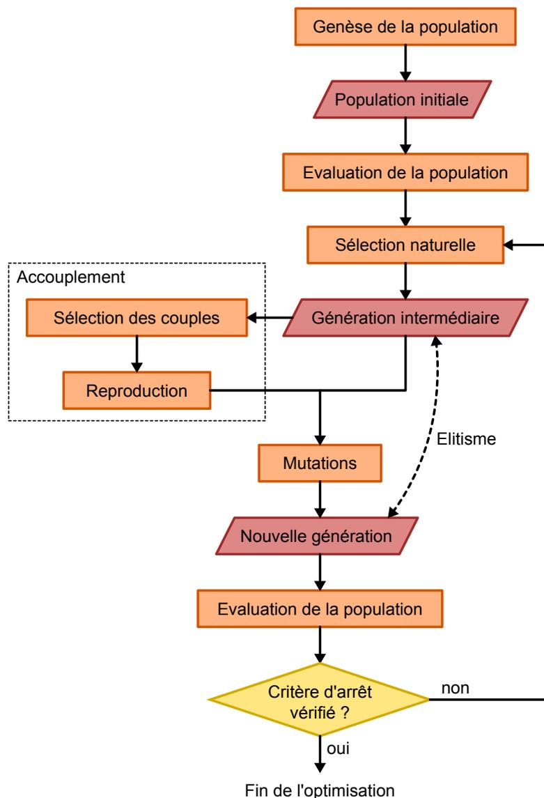
Figure 9.7 – Organigramme de fonctionnement des algorithmes génétiques.
