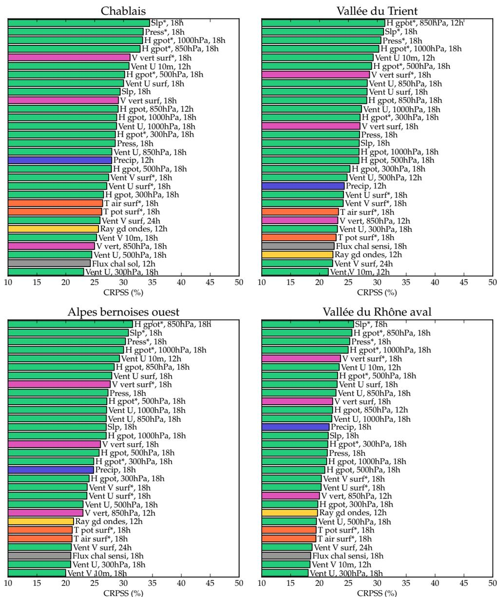
**Figure 7.1** – Graphiques des 30 meilleures variables des réanalyses en premier niveau d'analogie selon les groupements (la fenêtre spatiale est optimisée pour chaque variable). Le critère S1 est utilisé lorsqu'il y a un astérisque à côté du nom de la variable, autrement le RMSE est employé. La couleur représente le type de la variable : vert = circulation, bleu = humidité, orange = température, jaune = rayonnement, mauve = vitesse verticale, gris = autre.
