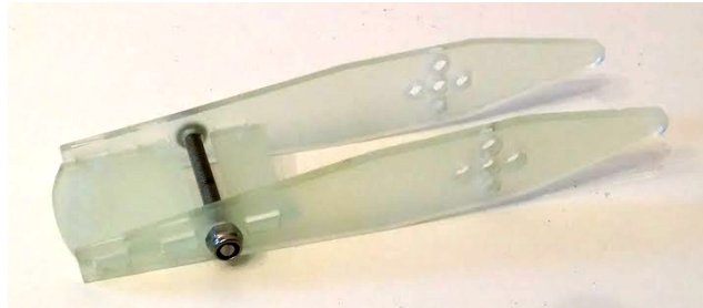
FIGURE 2.9 – Une longue vis et un emboîtement permet d'assembler la patte de Metabot laser sans pliage.
