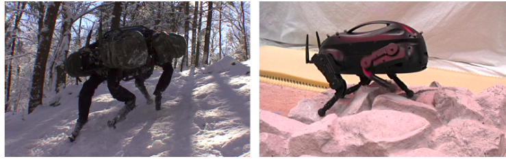
FIGURE 1.6 – Big Dog (à gauche) et Little Dog (à droite) sont deux célèbres robots de recherche utilisés pour expérimenter la marche sur des terrains irréguliers.
