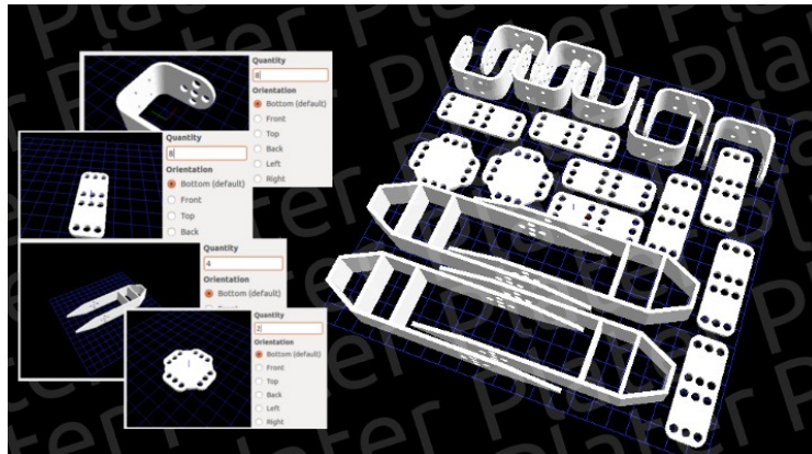
FIGURE 3.9 – Notre logiciel Plater, open-source, avec une interface graphique qui permet de générer automatiquement des plateaux contenant un ensemble de pièces.
