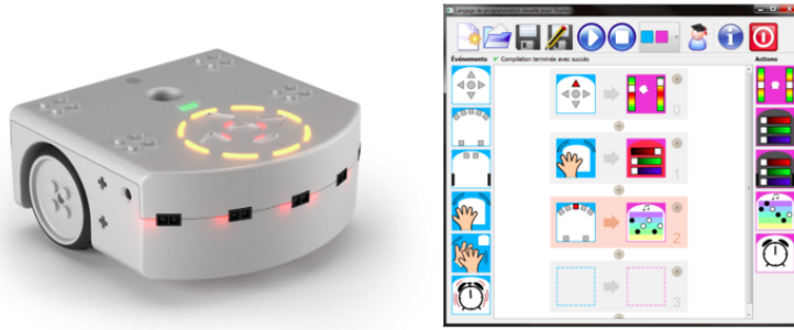
FIGURE 2.18 – Le robot Thymio et son environnement de programmation simplifié basé sur des événements.
