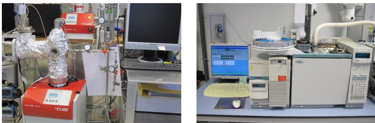
Figure 2-17 : Spectromètre à secteur magnétique R30 (à g.) et spectromètre à secteur quadrupolaire Agilent 5973N couplé au chromatographe en phase gazeuse Agilent 6890 (à d.)
