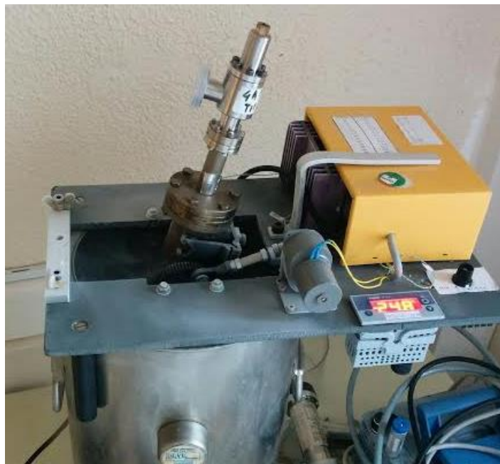
Figure 4-1 : Dispositif d'agitation pendulaire des cylindres de zéolithes
