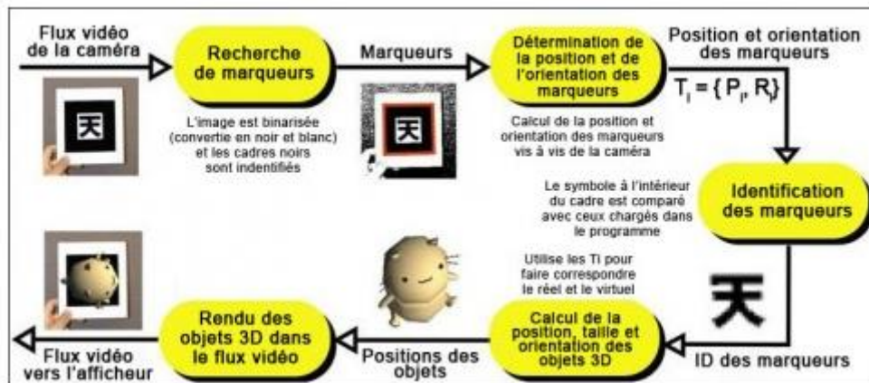
Figure I-18. Traitement d'image utilisé dans ARToolkit [32]
