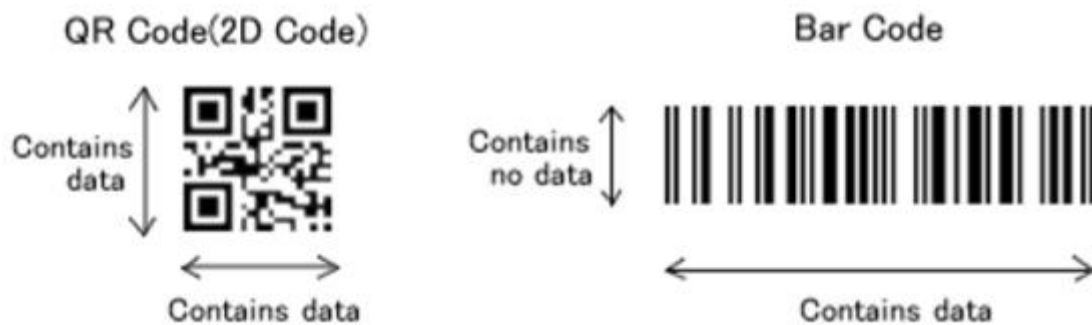
Figure I-14. Comparaison entre un QR Code et un code barre [26]
