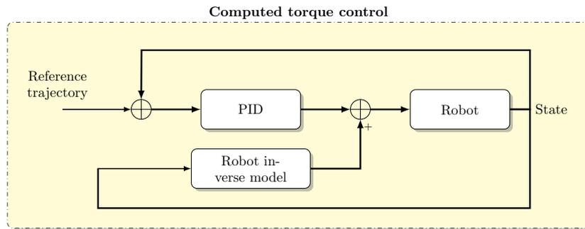
Figure 1.2: Principe de la méthode de commande utilisée.
