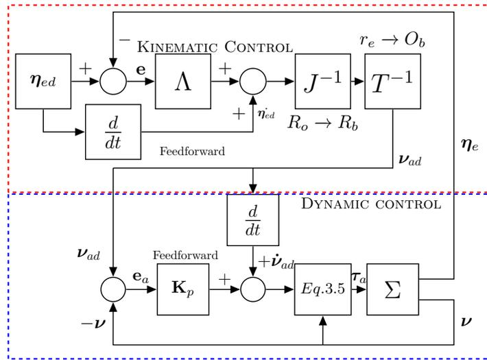
Figure 1.3: Commande par bouclage linéarisant.
