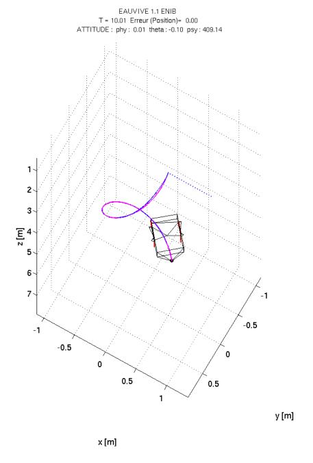
Figure 5.11: Test trajectory for EKF (refence trajectory: magenta, actual trajectory: blue).
