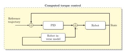
Figure 1.2: Principe de la méthode de commande utilisée.
