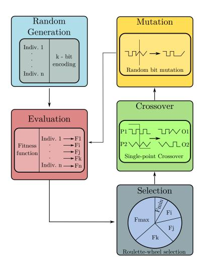
Figure 1.4: Algorithme génétique
