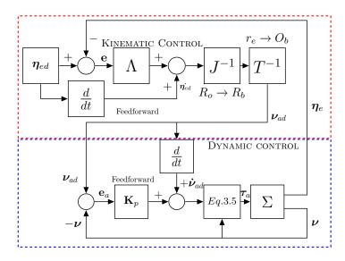
Figure 1.3: Commande par bouclage linéarisant.
