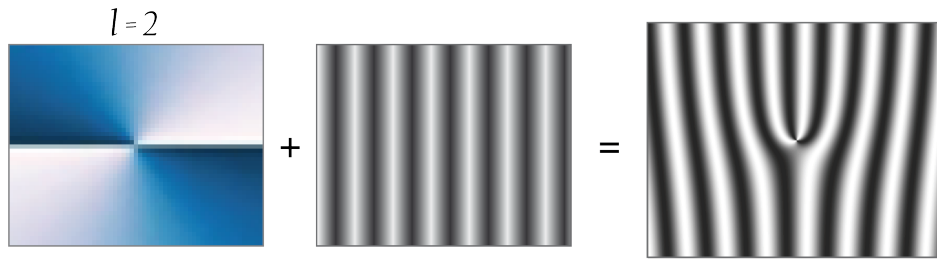
FIGURE 10.6: Interférences d'une onde plane et d'un faisceau vortex – La somme des champs de deux ondes planes séparées d'un angle \theta a une phase linéaire avec la position dans un plan orthogonal à la propagation moyenne. Celle-ci est tracée modulo 2\pi au panneau central. Si l'un des faisceaux est un vortex de charge l , exemple avec l = 2 panneau de gauche, la somme des phases est en fourche d'ordre l , panneau de droite.
