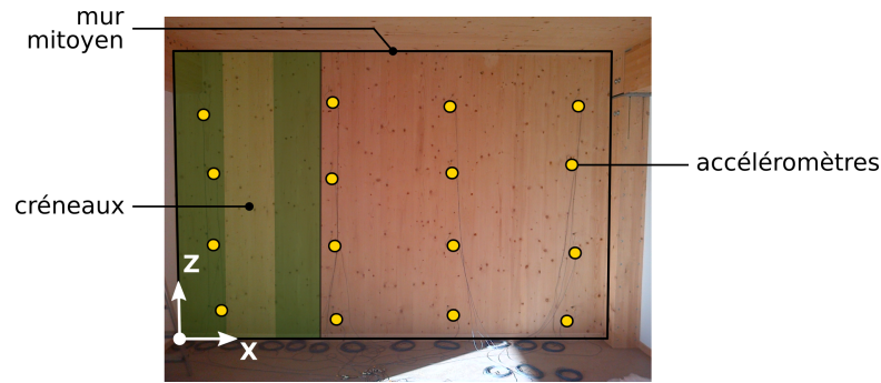
FIGURE 1.19 – Détail de la position des accéléromètres (points jaunes) sur la paroi instrumentée et des créneaux permettant de rigidifier la structure (rayures vertes).
