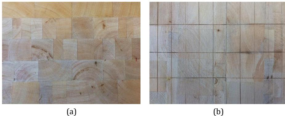
FIGURE 2.15 – *Panneaux de balsa utilisés : a) Panneaux rigides et b) Panneaux recoupés.*
