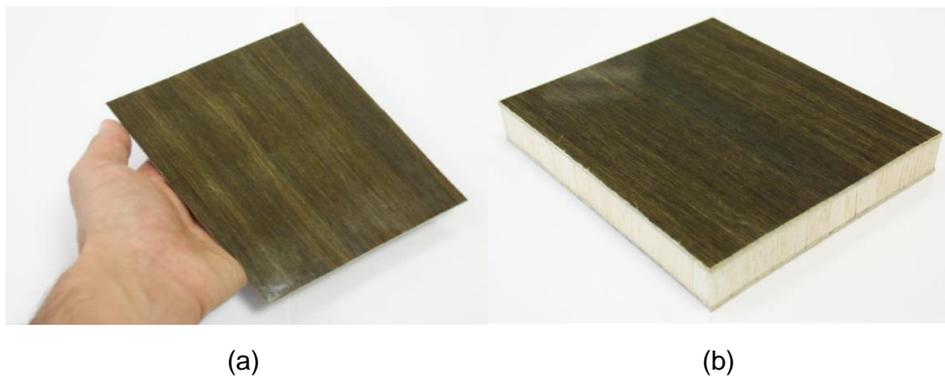
FIGURE 2.30 – Exemple de pièces réalisées. a) composite stratifié et b) plaque sandwich.
