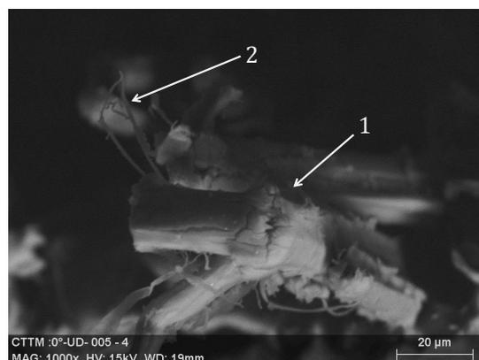
FIGURE 3.18 – Endommagement d'une fibre élémentaire dans un spécimen UD-o
