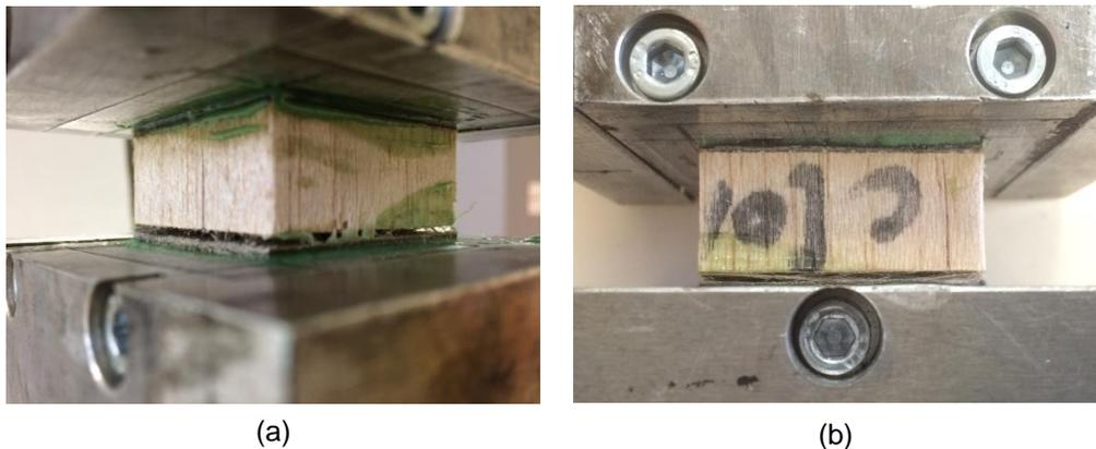
FIGURE 4.3 – Mode de rupture observés : a) rupture d'interface peau/âme et b) délaminage de la peau
