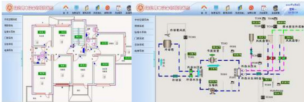
Figure 5 Interface client (gauche) et de supervision (droite) du système de chauffage, ventilation et climatisation d'un bâtiment du campus de la Shandong Jianzhu University (Chine) (Wang et al., 2011)
