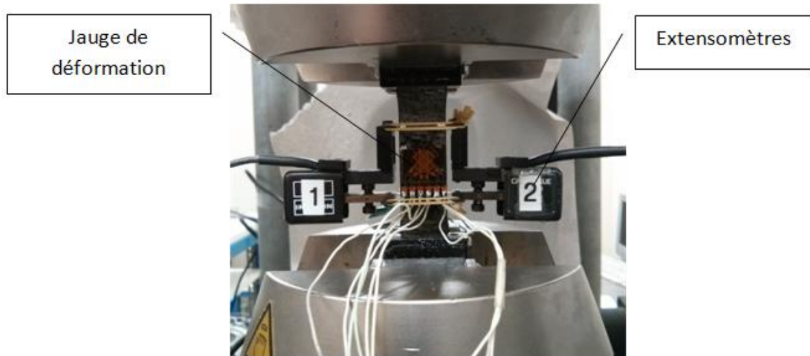
Figure II-16 : Mise en place de l'éprouvette équipée de deux extensomètres et de jauges de déformation
