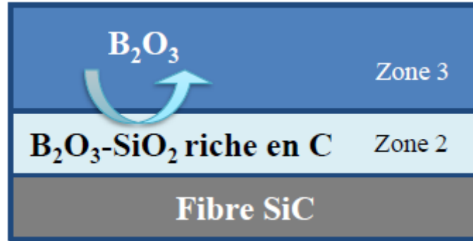
Figure I-20 : Schématisation de la couche intermédiaire en Si-B-C-O entre la fibre et le verre B_2O_3 formée lorsque des fibres SiC sont plongées dans du B_2O_3 à haute température sous air [Nualas-2013]
