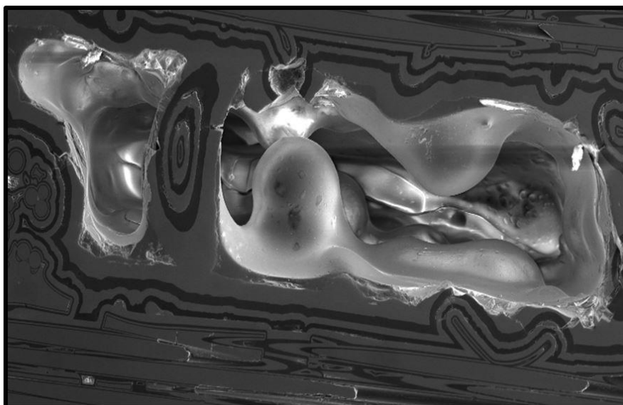
Figure V-33 : Phénomène de glacure des surfaces des macropores présent dans le matériau une fois l'oxyde solidifié. Traction résiduelle suite à l'essai « plateaux thermiques/156 MPa », atmosphère ambiante. Cliché obtenu par microscopie électronique à balayage, Cerasep®A40C
