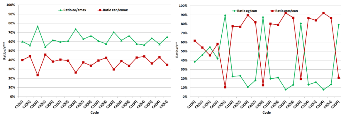
Figure IV-25 : Part de déformation (A) anélastique et élastique au sein des déformations maximales (B) résiduelle et anélastique réversible au sein des déformations anélastiques au cours de l'ensemble des cycles de caractérisations durant l'essai à 800°C et 72 MPa, 225h, sous air ambiant, Cerasep®A40C
