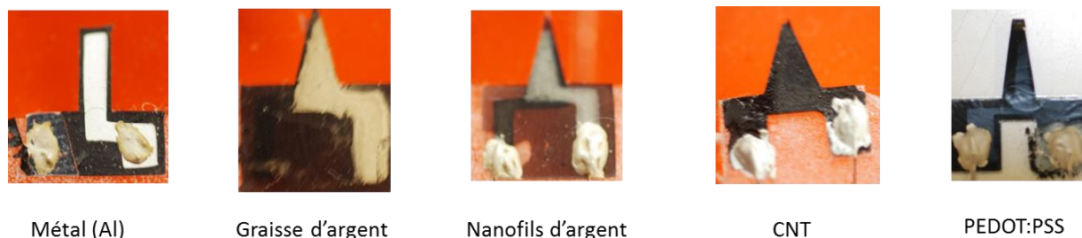
Figure 3.24 : Photographies des micropoutres électrostrictives avec différents types d'électrodes supérieures
