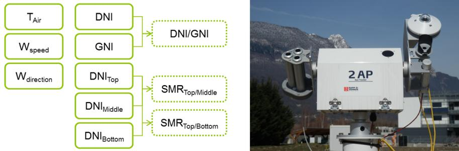
Figure 2.4: Schéma des données mesurées par la station météorologique (gauche) et photographie des capteurs montés sur le suiveur Kipp & Zonen (droite).
