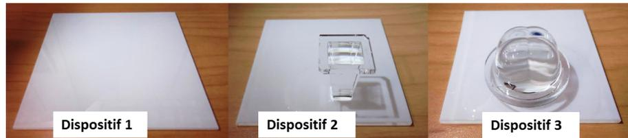
Figure 4.3: Photographie des diffuseurs utilisés dans le cadre de l'étude. De droite à gauche: diffuseur sans SOE, diffuseur avec pyramide réfractive inversée, et diffuseur avec optique secondaire de Fresnel-Köhler.
