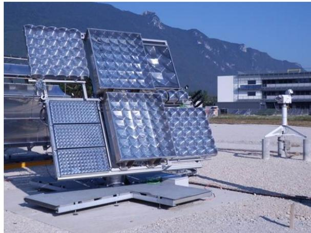
Figure 2.3: Photographie du suiveur solaire deux axes du CEA avec plusieurs modules CPV installés.
