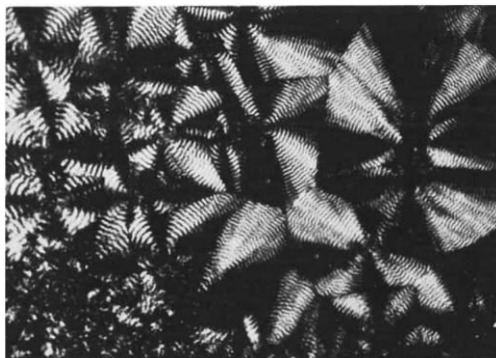
Figure I.28 - PA11 refroidi de 230°C jusqu'à température ambiante après une chauffe de 30min [155]
