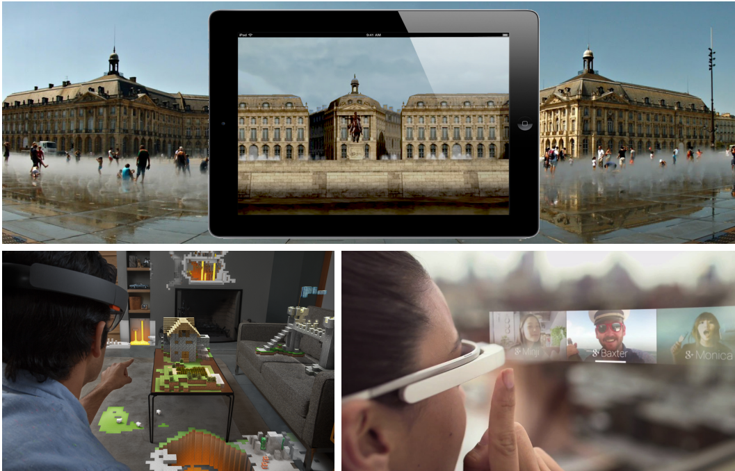
FIGURE 5– Réalité augmentée see-through. Exemple d’augmentations possibles avec une tablette (haut), avec le Microsoft Hololens (gauche) ou avec les Google Glass (droite) (PhilippePierre, Wikipedia). Dans le cas de la tablette, une image est acquise par la caméra, modifiée et affichée sur l’écran pour montrer une restauration historique du lieu. Dans le cas de Hololens, des éléments 3D peuvent être incrustés dans le monde réel, comme ici avec un terrain et des habitations virtuelles. Les Google Glass permettent quant à elle d’afficher des images 2D flottantes, sans pour autant qu’il n’y ait de superposition avec le monde réel.
