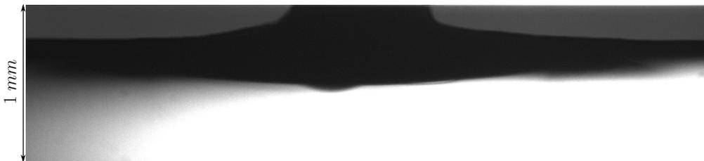
Figure 6.15: Formation d'un pont liquide pour  $H_1 = 733.8 \mu\text{m}$  et pour une puissance absorbée de  $24 \text{ mW}$ .
